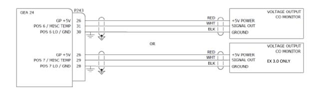
MAKE SURE THE BLACK GROUND WIRE IS GROUNDED TO AIRCRAFT GROUND AS THE PIN GROUNDS (E.G. PIN 30 AND 28) ON THE GEA 24 MAY NOT ALWAYS BE CONNECTED TO AIRCRAFT GROUND.
